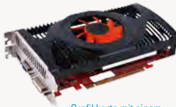
Grafikkarte mit einem Ventilator zur Kühlung.
